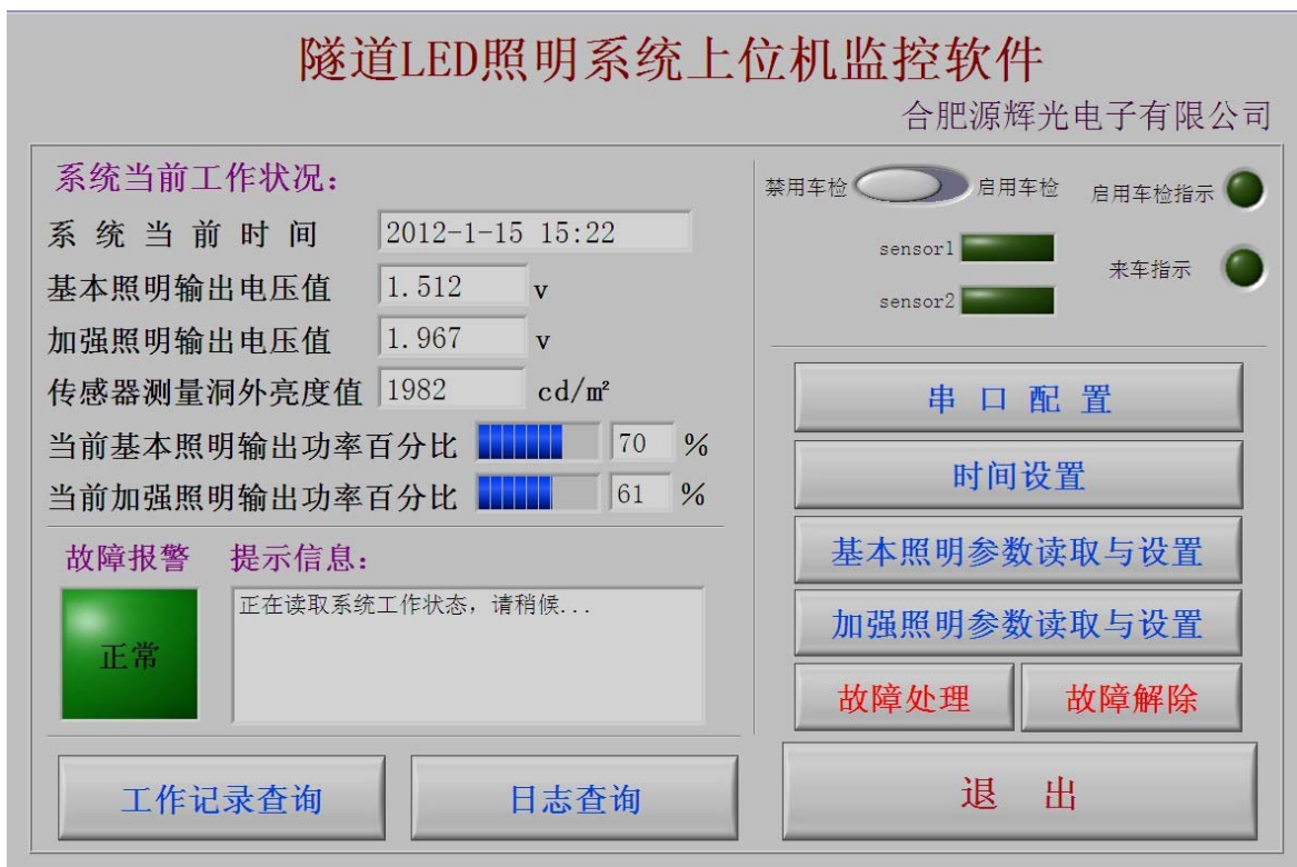
图 2-2 隧道 LED 照明系统上位机监控管理软件
